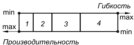
Рис. 1.4. Соотношение гибкости и производительности для серийного производства
