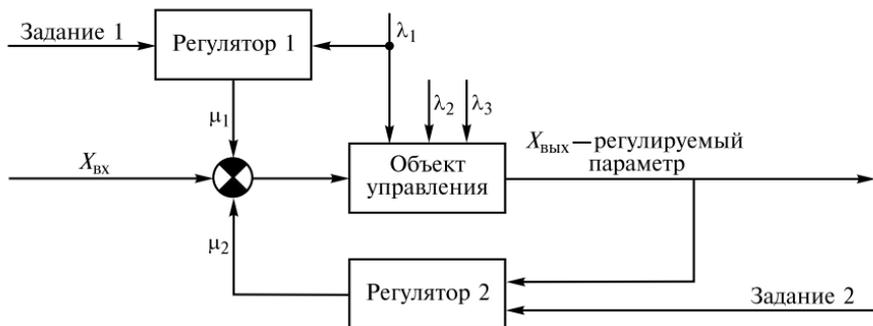
Рис. 1.14. Структурная схема комбинированной САУ
