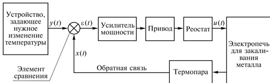
Рис. 1.4. Функциональная схема автоматической системы, реализующей процесс закаливания металла в электропечи
