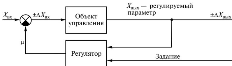
Рис. 1.12. Структурная схема САУ по отклонению
