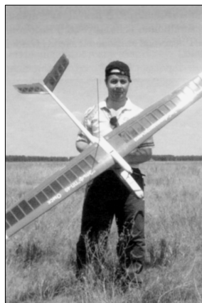
Рис. 1.5. Беспилотный летательный аппарат (БПЛА) «Эльф ПП-40» для производства крупномасштабной аэро съемки
