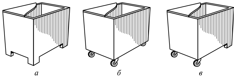
Рис. 1.6. Тара-оборудование: a — ТОС; б — ТОК; в — ТОСК
