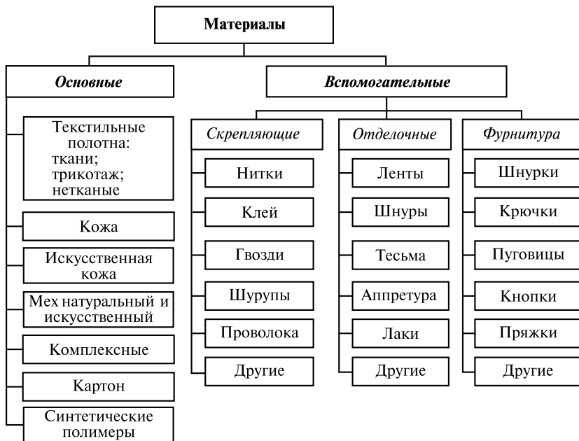
Рис. 1.2. Общая схема классификации материалов, применяемых в производстве обуви
