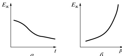
Рис. 1.1. Форма зависимости модулей упругости жидкостей от температуры (а) и давления (б)
