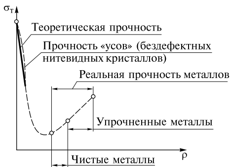
Рис. 1.4. Зависимость предела текучести \sigma_T от плотности \rho дислокаций
