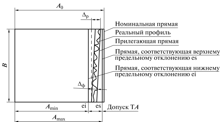
Рис. 1.10. Геометрическое представление допуска номинального размера, формы и расположения в сечении плоской детали
