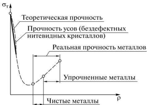
Рис. 1.5. Зависимость предела текучести  $\sigma_T$  от плотности  $\rho$  дислокаций
