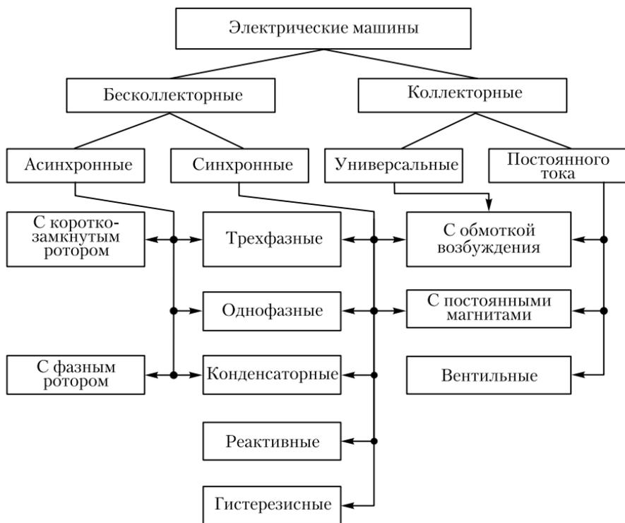
Рис. В.4. Классификация электрических машин
