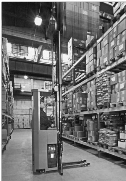
Рис. 1.4. Торгово-складской стеллаж для складирования грузов на поддоны с боковой загрузкой
